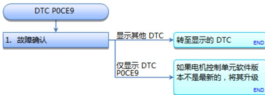
**DTC P0CE9:** 电子动力系统冷却液泵不可控
